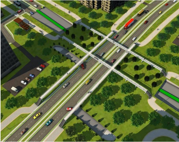
Рисунок 5 – архитектурно-планировочное решение развязки (вид сверху)
