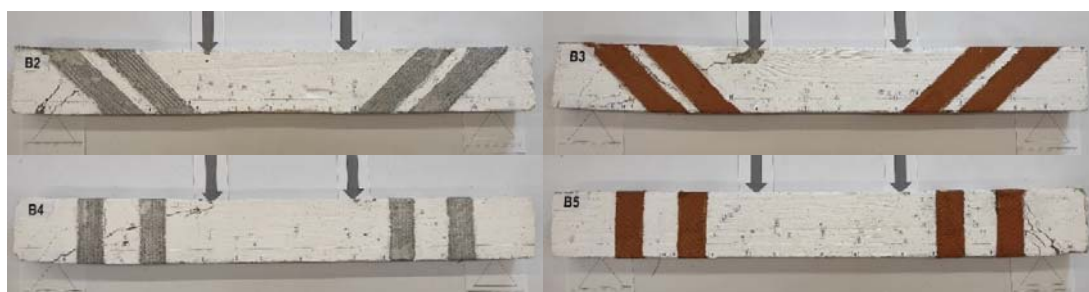
Рис. 1 – Характер разрушения опытных образцов
