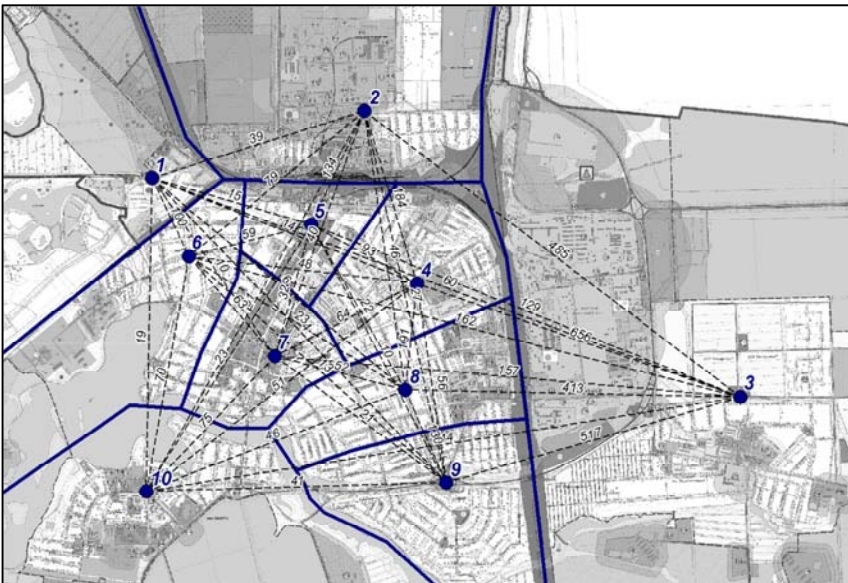
Рис. 4.2. Диаграмма для построения матрицы межрайонных корреспонденций, пассажиров в утренний максимальный час в двух направлениях
