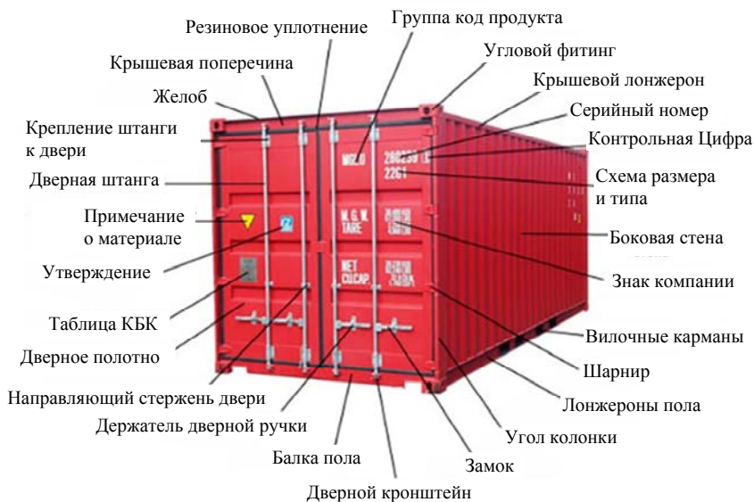
Рис. 6.8. Конструкция грузового контейнера и его маркировка
