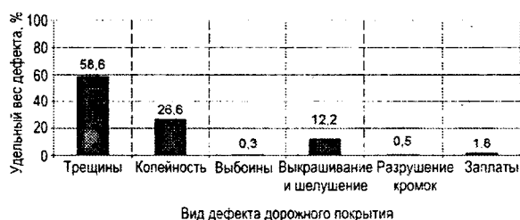
Рис. 2. Виды повреждений покрытий республиканских автомобильных дорог
