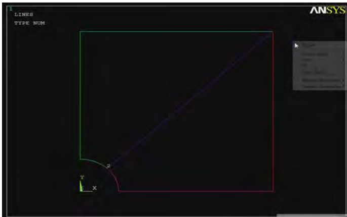
Рис. 1.28. Создание дополнительной линии для успешного разбиения регулярной сетки
