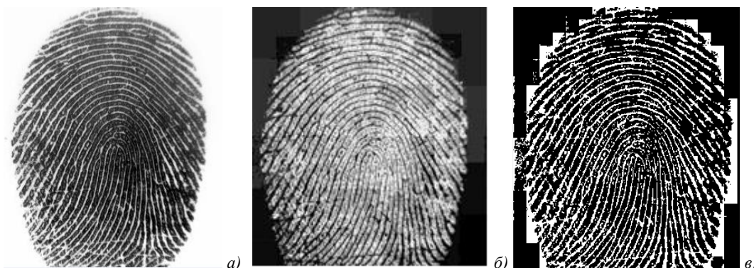
Рис 1. Изображение, полученное со сканера отпечатка пальцев (а), изображение после нормализации (б) и бинаризованное изображение (в).
