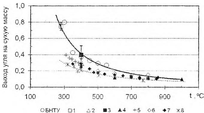
древесного угля в обжиговых печах. Степенная эмпирическая зависимость  $m_{yc} / m_o^c = at^b$ , где  $m_{yc}$  – масса угля,  $m_o^c$  – сухая масса исходной древесины,
