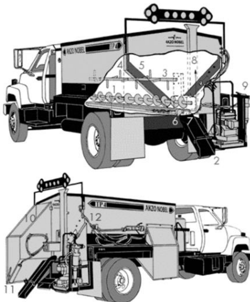
Рисунок 5 – Машина TP4 для ямочного ремонта покрытий:
