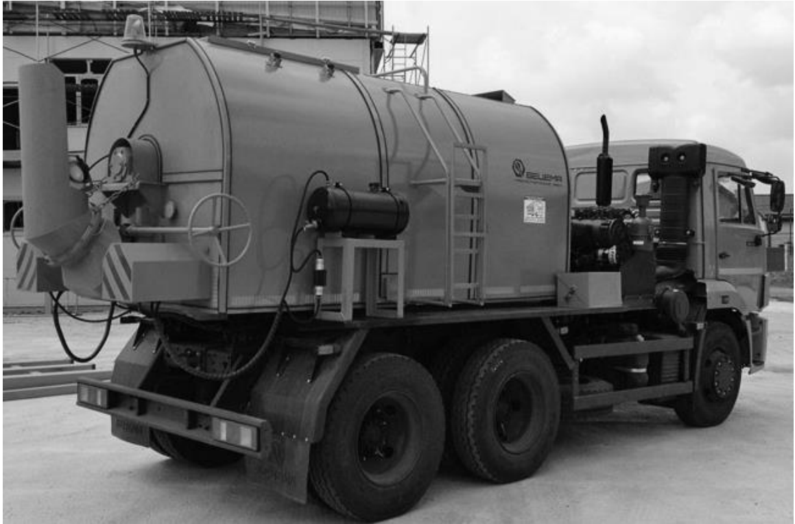
Рисунок 6 – Самоходный термос-миксер с горизонтальным расположением вала смесителя
