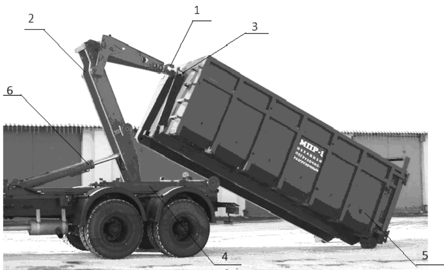
Рисунок 2 – Мультилифт с крюковым захватом Погрузка контейнера при помощи мультилифта осуществляется в соответствии со схемой, изображенной на рисунке 3.
