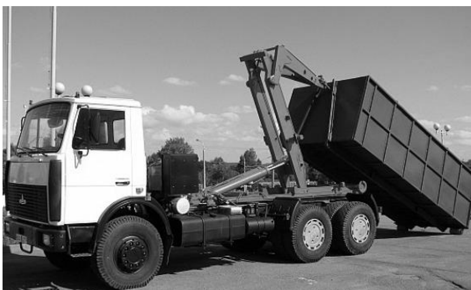
Рисунок 5 – Комплект машин по заготовке щепы для производства топливных брикетов а – машина лесная погрузочно-транспортная МПТ-461.2; б – мобильная рубильная машина МР-25; в – топливовоз с системой «мультилифт»
