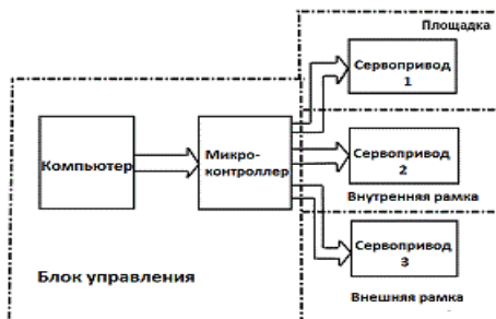
Рисунок 1 – Блок-схема макета управляемой платформы
