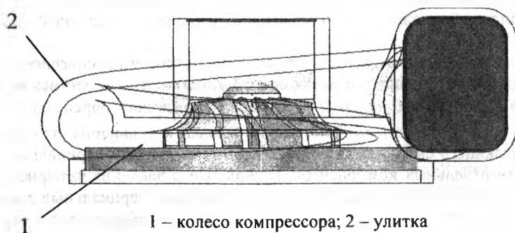
1 – колесо компрессора; 2 – улитка Твердотельная модель компрессора
