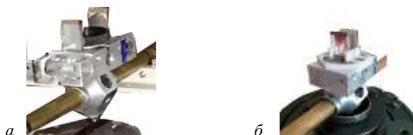
Рис. 1. Пример применения 3D принтера для модернизации маятника
