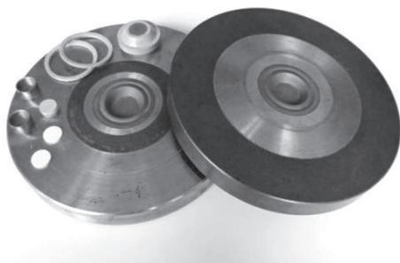
Рис. 1. Вид блок-матриц аппарата высокого давления и элементов реакционной ячейки
