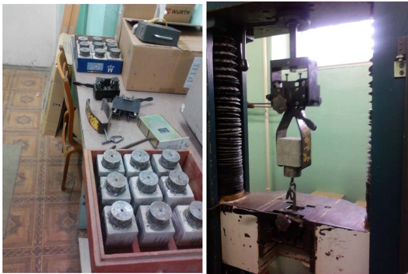
Рис. 4.14. Подготовка образцов и определение прочности сцепления с бетоном
