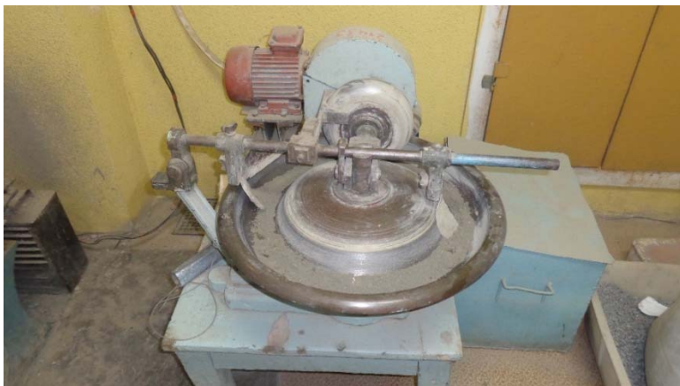
Рис. 2.5. Получение порошкообразного гидрофобного концентрата на бегунах смесительных
