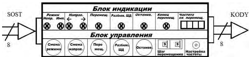
Рисунок 1 – Внешний вид устройства управления ШД
