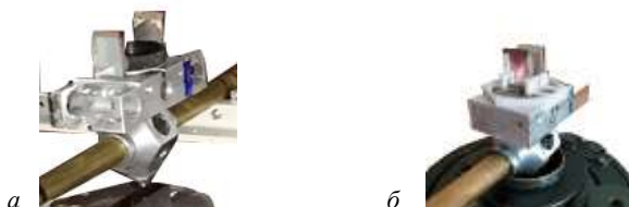
Рис. 1. Пример применения 3D принтера для модернизации маятника
