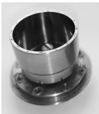
Рис. Волновой твердотельный гироскоп с металлическим резонатором
