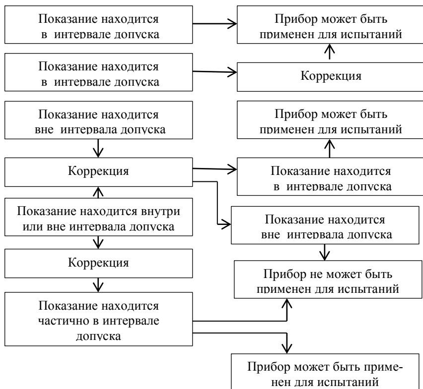
Рис. Сценарии принятия решений на основе соотношения неопределенности и интервала допуска
