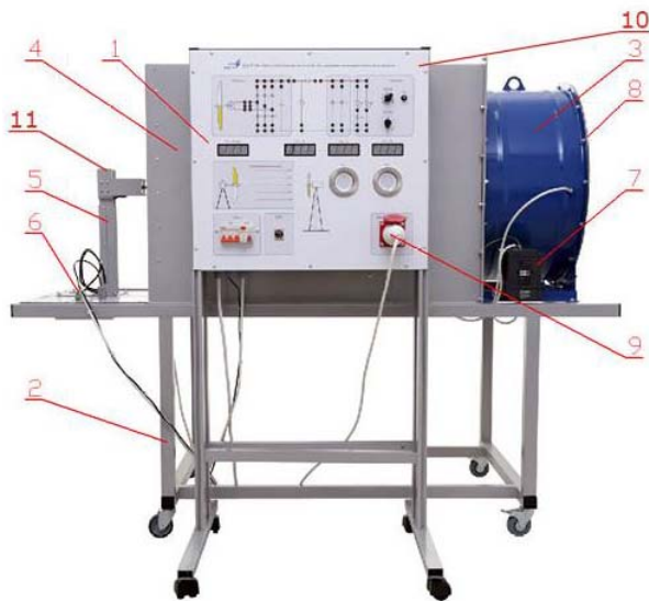
Рис. 1.2. Испытательная установка с блоком управления и измерения: 1 – блок управления; 2 – рама испытательной установки; 3 – центробежный вентилятор; 4 – кожух аэродинамического туннеля; 5 – стойка генератора; 6 – панель электрической коммутации; 7 – инвертор; 8 – защитная сетка (не показана); 9 – разъем подключения питания инвертора, генератор; 10 – лицевая панель, 11 – генератор
