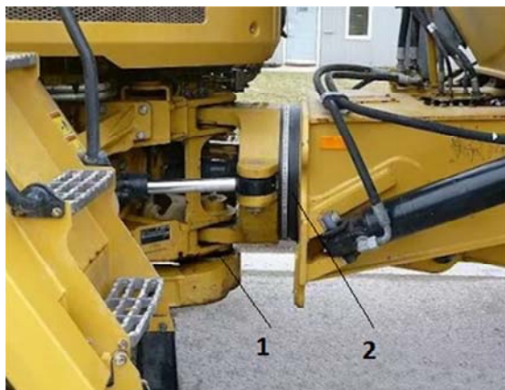
Рис. 2. Шарнирно сочлененная рама: 1 – вертикальный шарнир; 2 – горизонтальный шарнир
