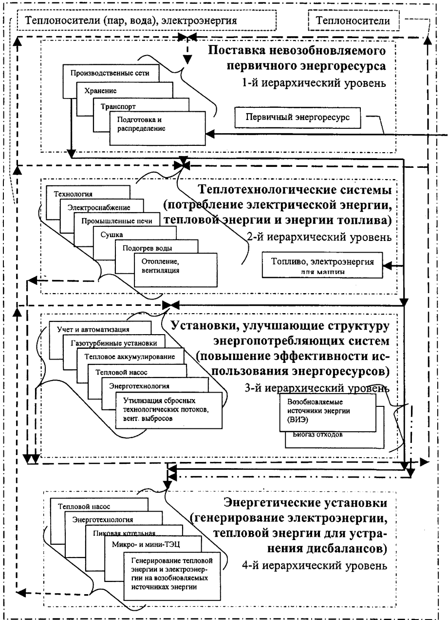
Рис. 1. Структурная схема теплоэнергетической системы с разнесением ее подсистем по иерархическим уровням
