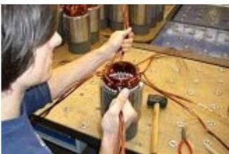
**Was machen Ingenieurelektroniker für Maschinen und Antriebstechnik?** Elektromotoren, wie beispielsweise Wechsel- oder Drehstrommotoren wandeln elektrische Energie in Arbeit um und treiben dadurch andere Maschinen an. Bei Generatoren z.B. Windgeneratoren ist es genau umgekehrt: hier wird durch mechanische Arbeit Energie erzeugt. Elektroniker für Maschinen und Antriebstechnik kennen sich damit bestens aus. Sie bauen diese
