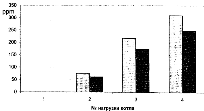
Рис. 4. Объект испытаний – котел БКЗ-75-39, топливо – мазут: ■ – CO, TESTO; ■ – CO, АГТ
