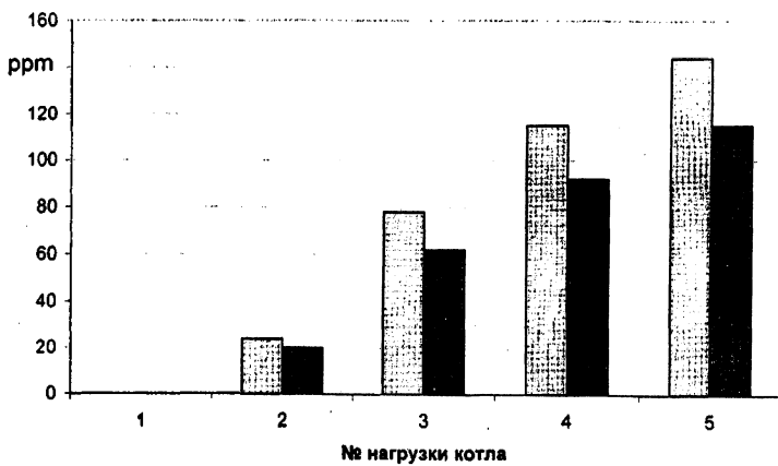
Рис. 5. Объект испытаний – котел БКЗ-210-140, топливо – газ: ■ – CO, TESTO; ■ – CO, АГТ
