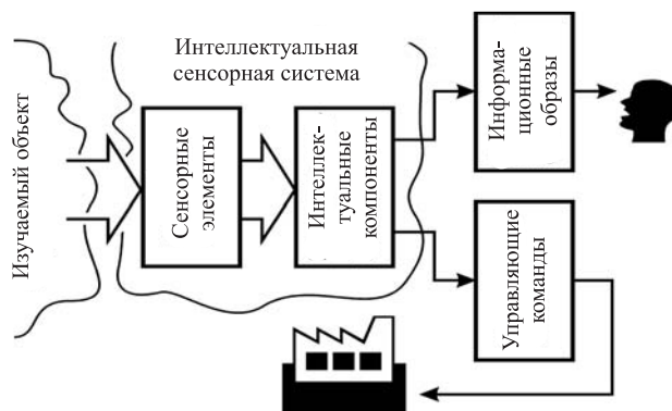
Рис. 1. Взаимосвязь сенсорных и интеллектуальных процедур при контроле параметров изучаемого объекта
