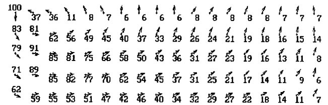
Рис.4. Поле скоростей в конце периода заполнения ковша, см/с
