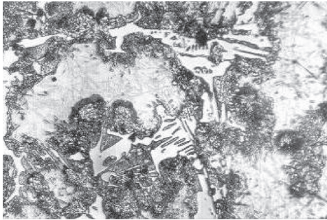
Рис. 1. Микроструктура сплава 200Г5Х2ТФЛ в литом состоянии. \times 500
