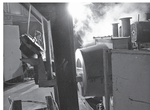
Рис. 4. Машина мод. 49101 с узлами автоматической покраски и дозированной заливки
