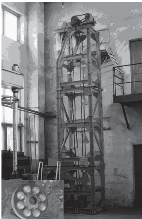
Рис. 7. Стенд для испытания мелющих шаров мод. П1755 и однорядный куст отливок шаров диаметром 60 мм
