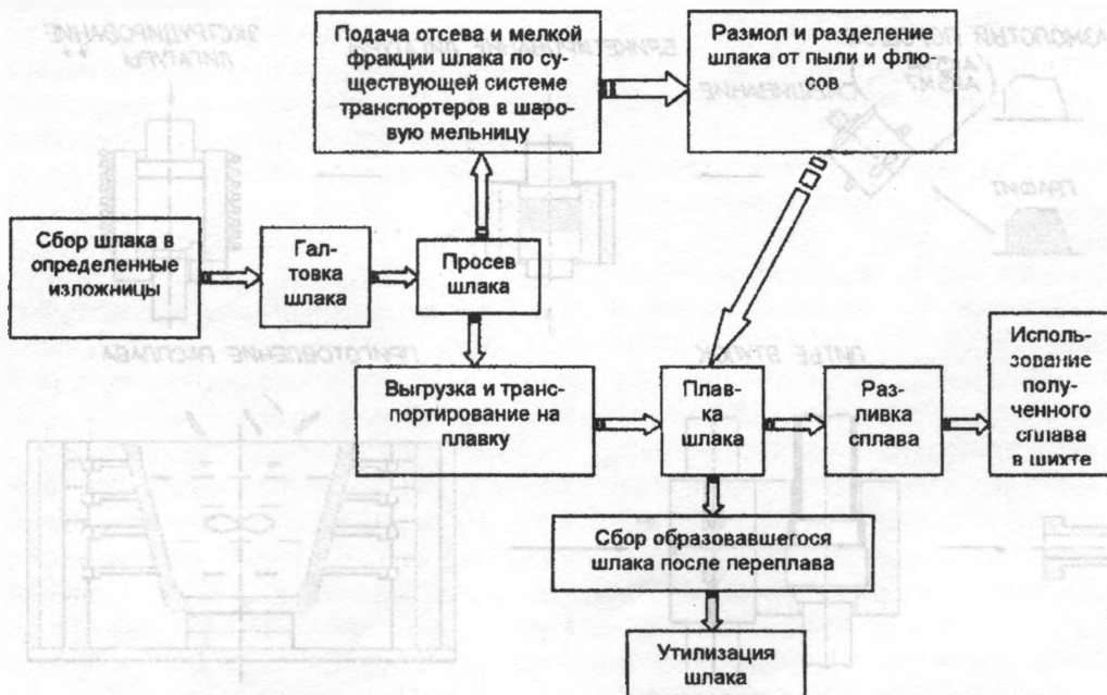
Рис. 7. Общая технологическая схема переработки шлака и получения вторичных сплавов, применяемая на ПРУП «ММЗ»
