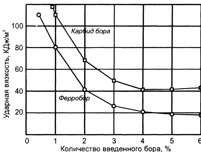
Рис. 1. Влияние состава шихты на ударную вязкость железобористых сплавов
