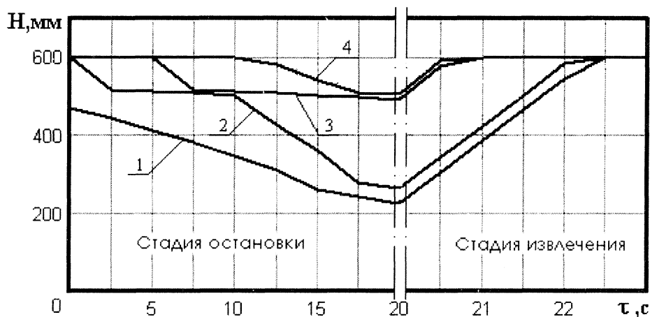
Рис. 3. Изменение глубины лунки на различных циклах вытягивания: 1 — на втором цикле; 2 — на третьем цикле; 3 — на пятом цикле; 4 — на восьмом цикле (при базовом варианте расчета)
