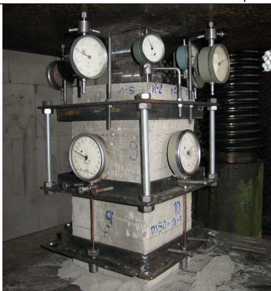
б) Рис. 1. Общий вид испытательной установки (а), вид образца-призмы размерами 150×150×300 мм непосредственно перед началом нагружения через штамп сечением 60×60 мм (б)
