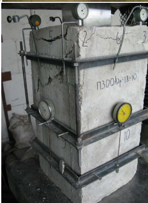
Рис. 3. Характер образования трещин и разрушение образцов-призм: неармированных (а), усиленных косвенным армированием (б)
