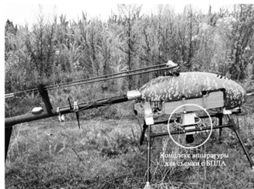
Рисунок 1 – БПЛА UVH-25EL, оснащенный спектрометром ФСР-04, перед вылетом
