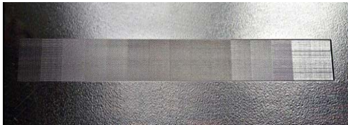
Рисунок 2 – Полученный образец полутонного клина на органическом стекле
