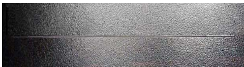
Рисунок 1 – Полученный образец полутонного клина на кварцевом стекле
