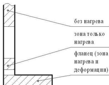
Рис.10. Схема вырезки образцов для проведения механических испытаний материала заготовок кожуха корпуса водила, изготовленных отбортовкой из трубы
