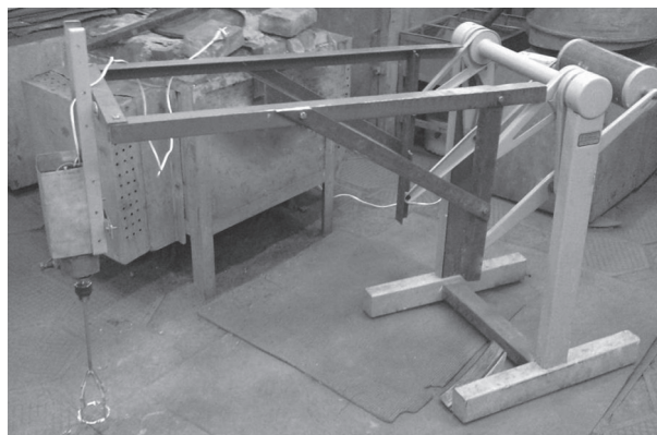
Рис. 3. Внешний вид опытно-экспериментальной установки для ввода частиц наполнителя в расплав алюминия в гетерофазном состоянии
