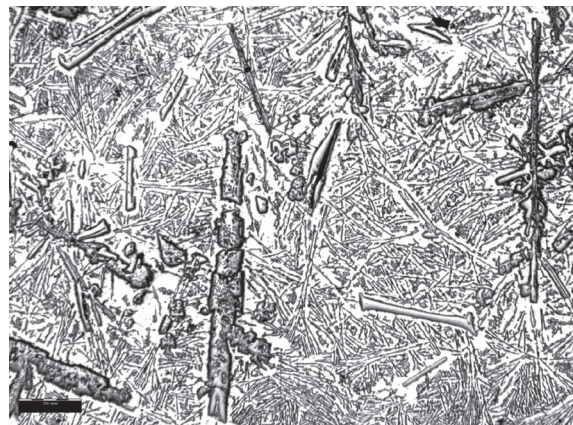
Рис. 11. Микроструктура образца сплава системы Al-Si, полученного методом прямого восстановления кремния из АКЛ (образец № 3) с содержанием 30 мас.% кварцевого песка
