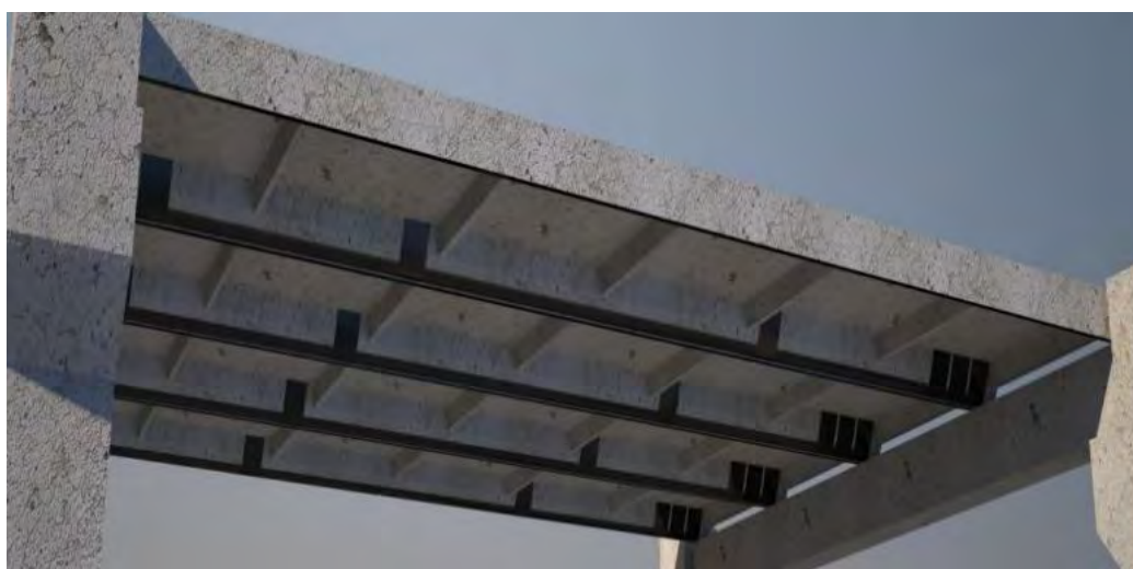
Рисунок 2 – Ребристые плиты усиленные углеволокном
