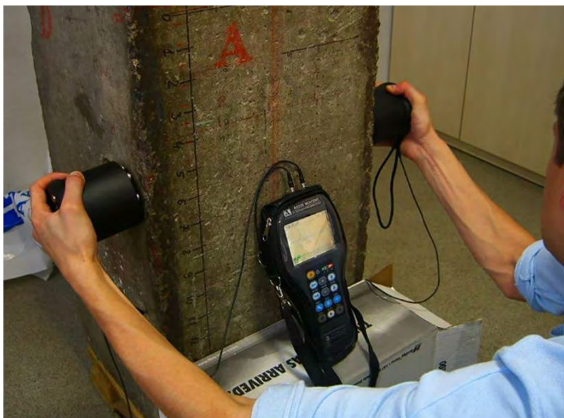
Рисунок 1 – акустический метод обследования бетонной конструкции
