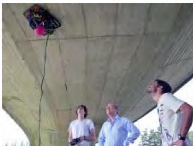
Рисунок 2 – C2D2 взбирается на стены и потолки для обнаружения коррозии
