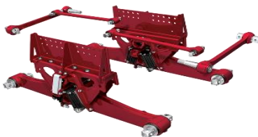
Рисунок 1 – Подвеска на резинометаллических упругих элементах
