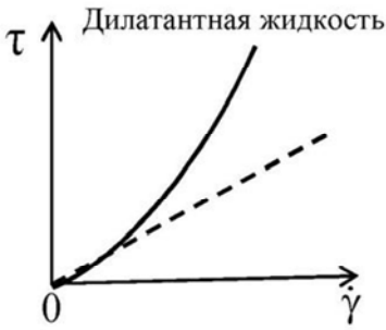
Рис. 2.1. Качественное изображение реологических кривых для различных жидкостей
