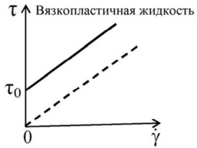
Рис. 2.1. Качественное изображение реологических кривых для различных жидкостей
