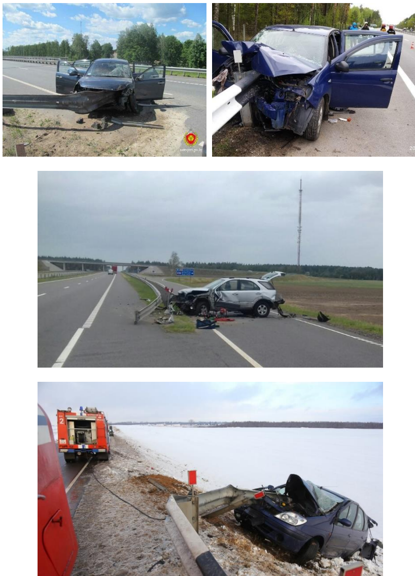
Рис. 2. Тяжесть последствия фронтального удара при ДТП
