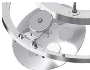
Рис. 2. Планетарный механизм с фрикционным зацеплением. Вид сверху
