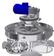
Рис. 4. Планетарный механизм с цепным зацеплением
