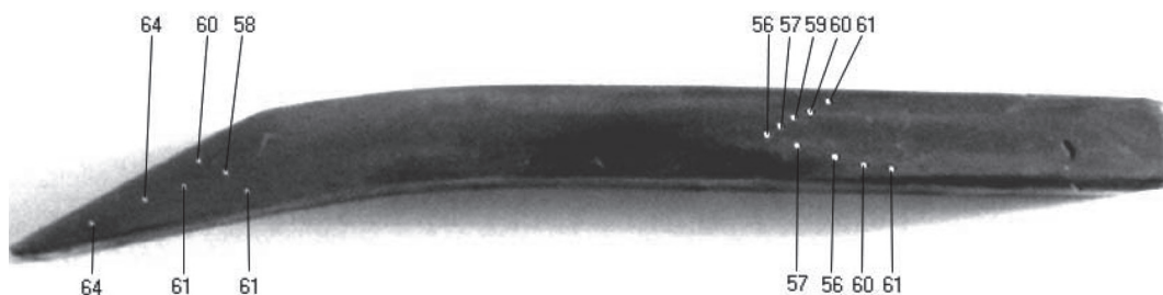
Рис. 9. Распределение твердости по глубине закаленной заготовки ножа кормоуборочного комбайна из стали 60ПП. Обработка: печной нагрев 850 \text{ }^\circ\text{C} , 25 мин, интенсивное охлаждение в воде
