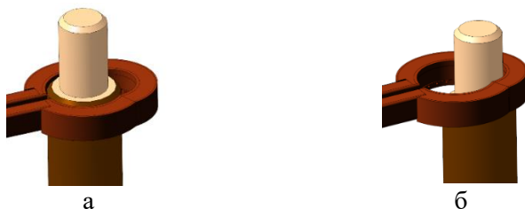
Рис. 2. Процесс закалки вала: а – конечное положение закалки большого диаметра вала; б – начальное положение закалки последней шейки вала
