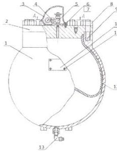
Рис. 1. Конструкция пневмогидроаккумулятора:
