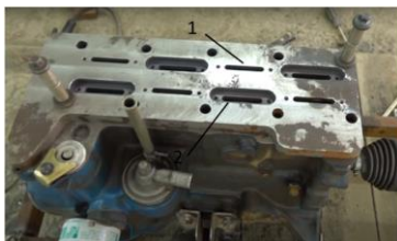
Рис. 1. Клапанная решетка: 1 – впускной канал; 2 – выпускной канал
