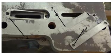
Рис. 2. Клапан пластинчатый: 1 – рамка; 2 – клапан; 3 – ограничитель
