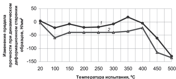
Рис. 4. Сопоставительные данные характера изменения значений временного сопротивления разрыву при динамическом деформационном старении образцов катанки диаметром 5,5 мм из стали Св-08Г2С с бором (1) и без бора (2) в зависимости от температуры испытания на растяжение
