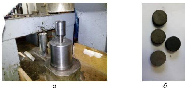
а б Рисунок 3 – Технологическая оснастка для отработки режимов деформации порошка комплексного силицида ( а ) и опытный образец полученного брикета ( б )
