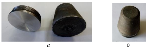
а – прессованная заготовка катода-мишени и стальной токовод; б – готовый катод-мишень
