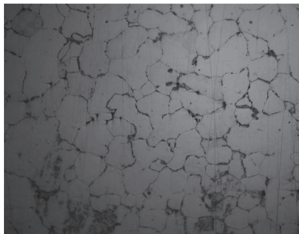
Рис. 10. Структура стали после модифицирования карбонатами в литом состоянии
