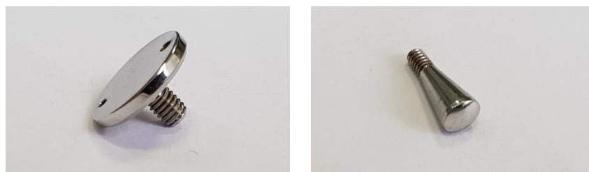
Рис. 2 – Образцы изделий из коррозионностойкой стали после полирования с применением управляемых импульсных режимов электролитно-плазменной обработки
