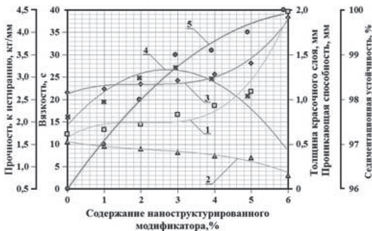
Рис. 1. Физико-механические свойства противопригарного покрытия, модифицированного наноструктурированным бемитом: 1 – толщина красочного слоя; 2 – проникающая способность; 3 – вязкость; 4 – прочность к истиранию; 5 – седиментационная устойчивость
